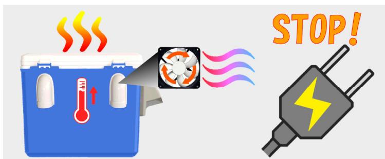
高温保護回路は、内部温度が上昇すると電動ファンが作動して熱を排出し、さらに高温の場合は出力を停止します。
