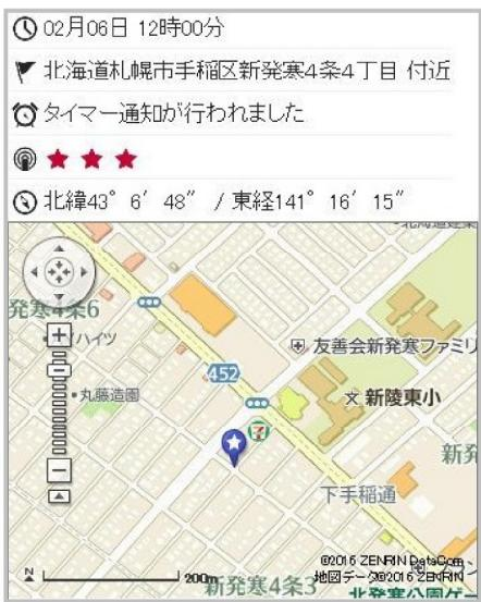
本装置は振動・移動・電気的な接触・遮断などの事象を感知し、感知内容や時刻に加えGPS位置情報をモバイル通信により即時に通報することの出来る多機能センサー機器です。
